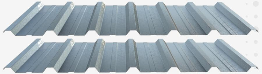
Telha de aço de trapézio baixo e boa largura útil. Flexibilidade para curvatura. Utilizada tanto em coberturas planas como em coberturas arqueadas. Pode ser aplicada em fachadas, tanto na posição vertical quanto na horizontal, podendo ser montado invertida, com um único perfil é possível obter diferentes aspectos em um mesmo chamento lateral.
